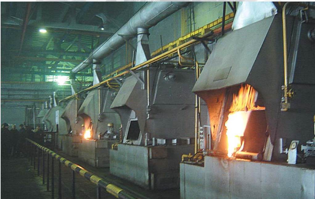
ПСЦ. Печи «Рекат» для закалки деталей
